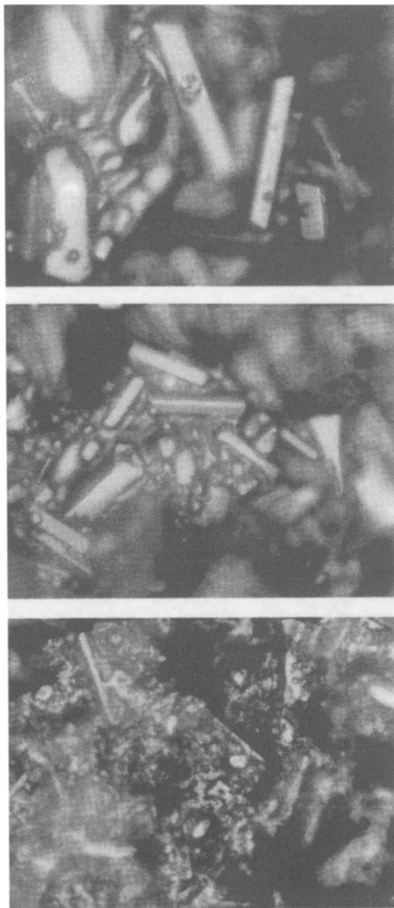
Abb. 1 Lichtmikroskopische Aufnahmen der Oberflächen von zersetzten YBCO-Proben; 1030°C für 15, 60 und 180 min, Vergrößerung 1000x
